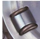
Закрытая конструкция пружин демпфера защищает от повреждения дорогостоящие детали муфты сцепления.
