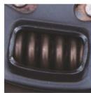
Каждый демпфер содержит 2 пружины для увеличения надежности конструкции и делает включение сцепления более плавным. Открытая форма ячеек, удерживающих пружины, предохранит маховик от контакта с металлической поверхностью диска в случае износа накладок.
